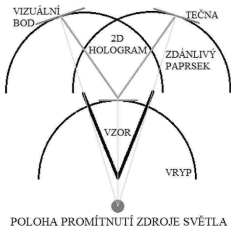
Obrázek 10.5: Geometrické řešení pro zvětšený hologram
