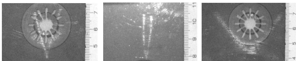
Obrázek 10.6: 2D hologram písmena „V” (a) podle schématu na obr. 10.4a, (b) podle schématu na obr. 10.4b, (c) podle schématu na obr. 10.5. Panely (a) a (b) se liší pouze poměrem vrypů, v panelech (a) a (c) je použité pouze jiné umístění zdroje světla; ostatní relevantní parametry jako poloha destičky vůči fotoaparátu apod. jsou s dostatečnou přesností zachovány.
